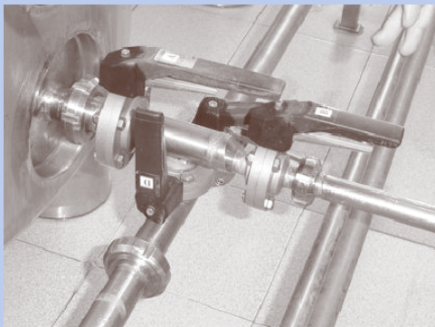
ภาพที่ 47 : วาล์วถังเก็บรักษานม สำหรับควบคุมการปล่อยนํ้านมออก
