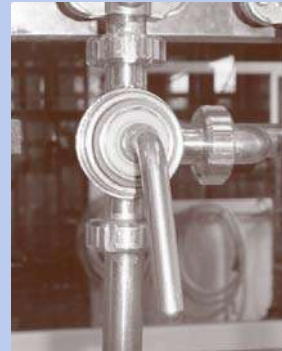
ภาพที่ 106 : Sanitary Plug Valve ชนิดสามทาง
