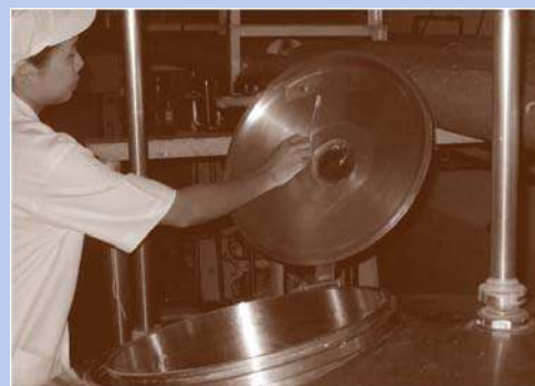
ภาพที่ 192 : การ Swab Test ฝาถังรอบบรรจุ
