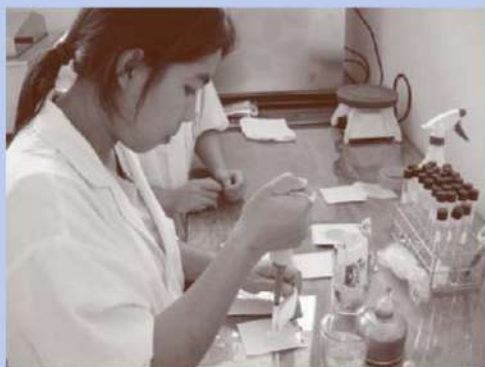
ภาพที่ 136 และ 137 : การตรวจนับจำนวนจุลินทรีย์โดยใช้ Petrifilm
