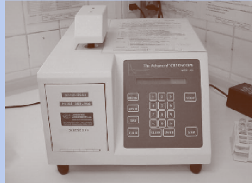
ภาพที่ 133 : เครื่องตรวจวัดจุดเยือกแข็ง (Cryoscope)
