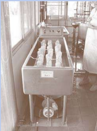
ภาพที่ 23 : ห้อง / บริเวณฆ่าเชื้อบรรจุภัณฑ์ประเภทขวด
