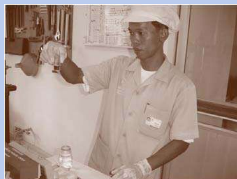
ภาพที่ 196 : การไตเตรทหาความกระด้าง
