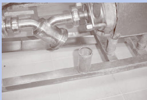
ภาพที่ 59 : อุปกรณ์กรองน้ำนมก่อนเข้าสู่ปั๊ม
