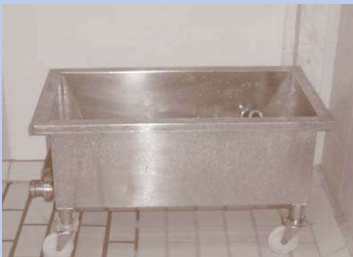
ภาพที่ 24 : อ่างแช่อุปกรณ์ต่างๆ เช่น ข้อต่อ วาล์ว
