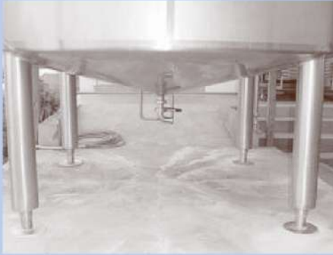
ภาพที่ 50 : ก้านถังที่ลักษณะเป็นกรวย ลาดเอียง
