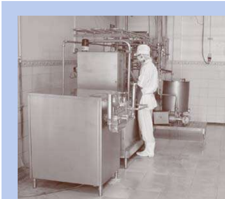
ภาพที่ 144 : การตรวจสอบระบบพาสเจอร์ไรส์ก่อนการผลิต
