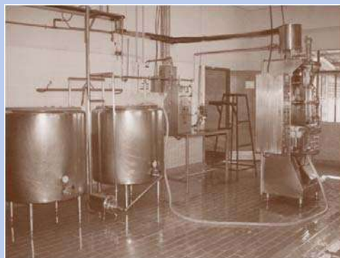
ภาพที่ 177 และ 178 : การล้างเครื่องบรรจุด้วยวิธี CIP
