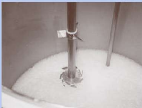
ภาพที่ 45 : ใบพัดชนิดรอบเร็ว
