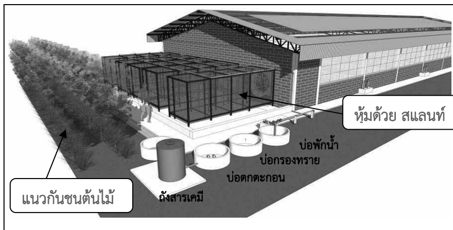
รูปที่ 7.3-8 ม่านกระจายน้ำกำจัดกลิ่นหลังพัคลมโรงเรือน
