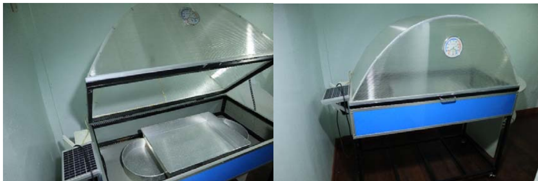
2) กระบวนการลดความชื้นโดยใช้เครื่องเป่าลมร้อน นำน้ำผึ้งชันโรงใส่ในถาดสแตนเลส วางไว้ในตู้เป่าลมร้อน ที่ควบคุมอุณหภูมิไม่เกิน 55\text{ }^{\circ}\text{C}^{2/}
